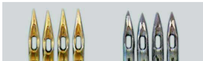
СРАВНЕНИЕ: GEBEDUR® (СЛЕВА) И СТАНДАРТНЫЕ ИГЛЫ (СПРАВА) ПОСЛЕ ИСПЫТАНИЙ
