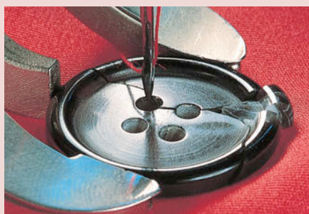
ПУГОВИЦА МОЖЕТ БЫТЬ ПОВРЕЖДЕНА
